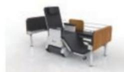
床椅一体化服务机器人集多功能护理床、智能电动轮椅、大小便处理装置和信息辅助系统功能于一体，提高了卧床老年人的生活自理能力和生活质量。可自动从护理床变形为轮椅，又可从轮椅反向变换回护理床，可大大减轻护理人员的负担，同时还扩大了被护理者的活动范围和独立生活能力。
